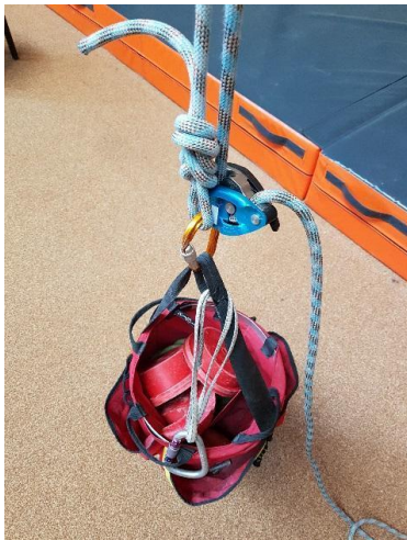
Routebouwtas gefixeerd met zekeringsapparaat aan naburig touw
