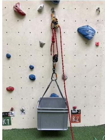
Bouwkraat gefixeerd met hijstouw en 1:3 hijssysteem
