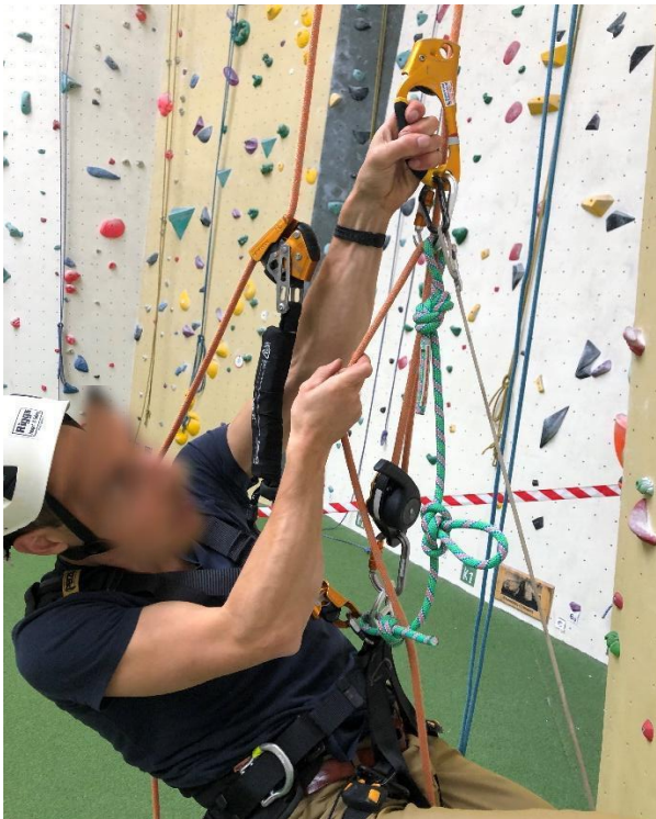
Gordel: industrieel. Touw: dynamisch. Afdaler: Petzl Rig. Back-up: Petzl ASAP met shock absorber. Methode: stijgen met afdaler en stijgklem. Remttouw door karabiner van stijgklem voor mechanisch voordeel (hier kan ook een katrol voor gebruikt worden).
