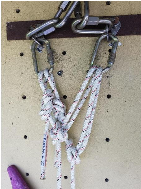
Twee statische touwen bevestigd aan twee haken van 1 top-anker. Beide haken worden belast.
