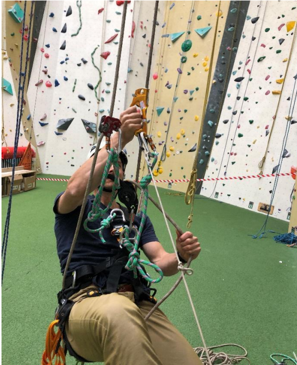
Gordel: industrieel. Touw: statisch. Afdaler: Petzl Rig. Back-up: Camp Goblin (bevestigd aan geknoopte lanyard van dynamisch touw). Methode: stijgen met stijgklem en afdaler.
