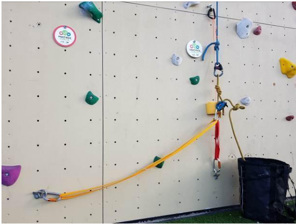
Rig to rescue; ankerpunt met back-up.
