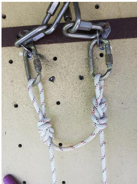
Twee statische touwen bevestigd aan twee haken van 1 top-anker. Er wordt altijd maar 1 haak belast, maar de touwen zitten wel aan elkaar vast als back-up.
