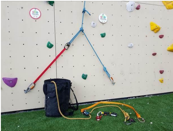
Krachten verdeeld over twee haken; ankerpunt met vooraf geïnstalleerde vlinderknoop voor redding. Reddingstas voorbereid.
